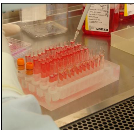
Figura 14 - Extrato sendo adicionado e homogeneizado nos tubos de vidro com meio DMEM.
