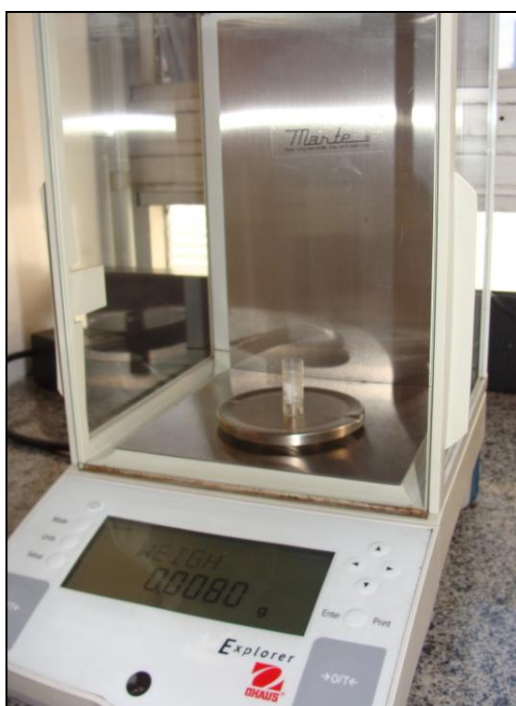
Figura 3 - Balança analítica com tubo de criogenia de dois mL, onde o extrato bruto foi pesado na concentração de 40 mg/mL
