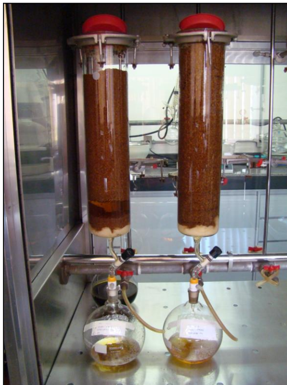
Figura 2- Percoladores de vidro, com o conjunto pó-mistura de solventes.
