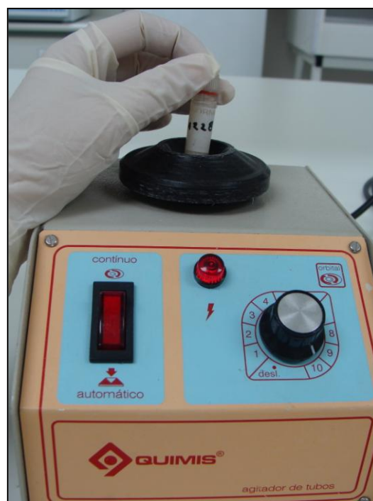
Figura 4 - Tubo de criogenia, com extrato e solvente, colocados no vórtex até ocorrer a diluição completa do extrato.
